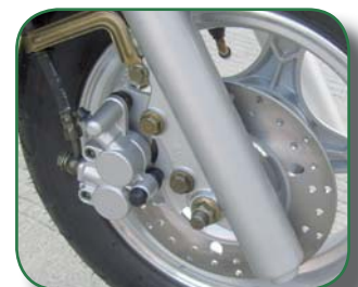
Scheibenbremse: sicherer Halt auch bei voller Zuladung
