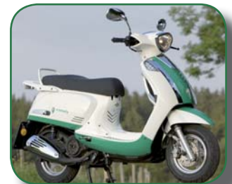
Viertakt-Emmely: mit 50- oder 125-cm 3 - Einzylindermotor
